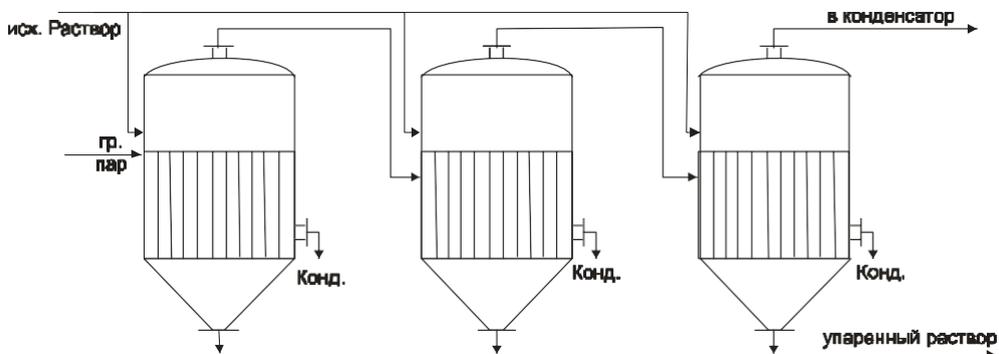
**Рис. 13.4 Многокорпусная прямоточная вакуум-выпарная установка**
