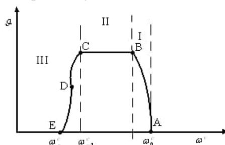
Точка D – вторая критическая – соответствует достижению равновесной влажности на поверхности материала. Начиная с этого момента скорость сушки перестаёт зависеть от внешних условий, а определяется скоростью внутренней диффузий влаги из глубины материала к его поверхности материала в процессе сушки сопровождается изменением температуры материала. И эта кривая находится в соответствии с кривой сушки.
