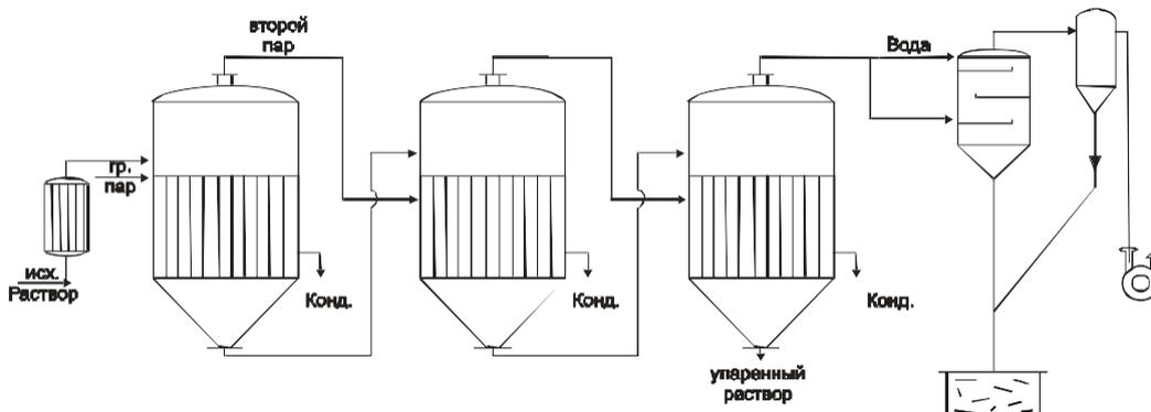
**Рис. 13.2 Многокорпусная прямоточная вакуум-выпарная установка**
