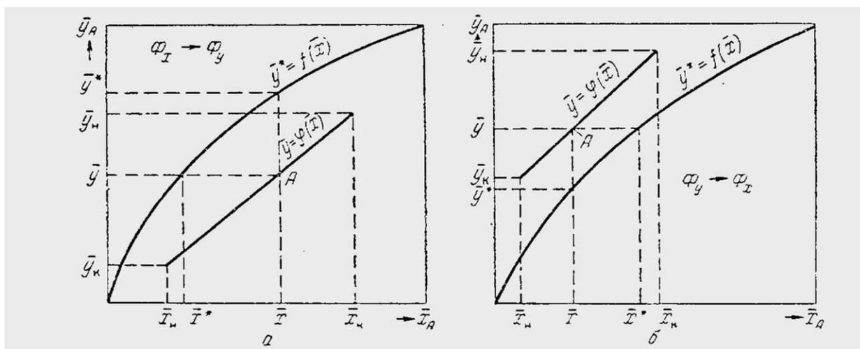
**Рис. 14.3** Определение направления массопередаче по у-х-диаграмме:
