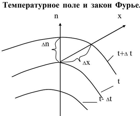
**Температурное поле и закон Фурье.** Теплопроводность определяется тепловым (хаотическим) движением микрочастиц тела. В теории теплопроводности вещество рассматривается как сплошная среда, перенос теплоты в которой (при отсутствии конвекции и излучения) обусловлен наличием разности температур.
