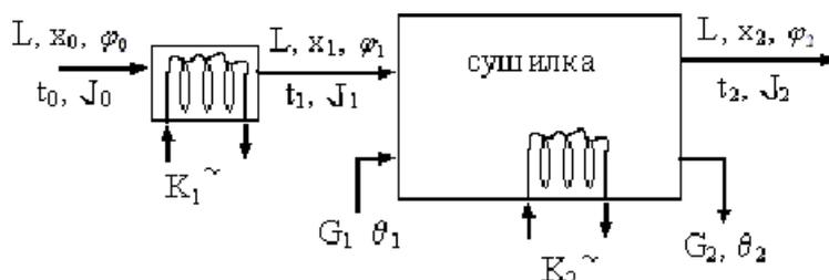
Пусть в сушилку поступает  $G_1$  кг/ч влажного материала, имеющего температуру  $\theta_1^0 C$ . Из сушилки выходит  $G_2$  кг/ч сухого продукта с температурой  $\theta_2$ . В сушилку поступает сушильный агент, содержащий  $L$  кг/ч абсолютно сухого воздуха. Влажность сушильного агента  $\Phi_1$ , температура  $t_1$  и энтальпия  $J_1$ . Предварительно воздух - подогрывается в калорифере  $K_1$ . Перед калориферам параметры воздуха  $x_0, y_0, t_0, J_0$ . В
