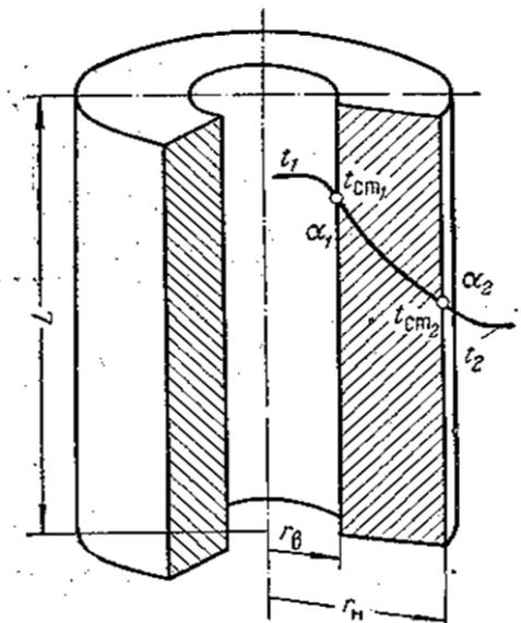
передача тепла часто происходит, что внутри трубы находится более нагретый воздух с температурой  $t_1$  и коэффициентом теплоотдачи от него к цилиндрической стенке  $\alpha_в$ . Снаружи – более холодный теплоноситель, имеющий температуру  $t_2$ . Коэффициент теплоотдачи от наружной стенки к холодному теплоносителю  $\alpha_н$ .
