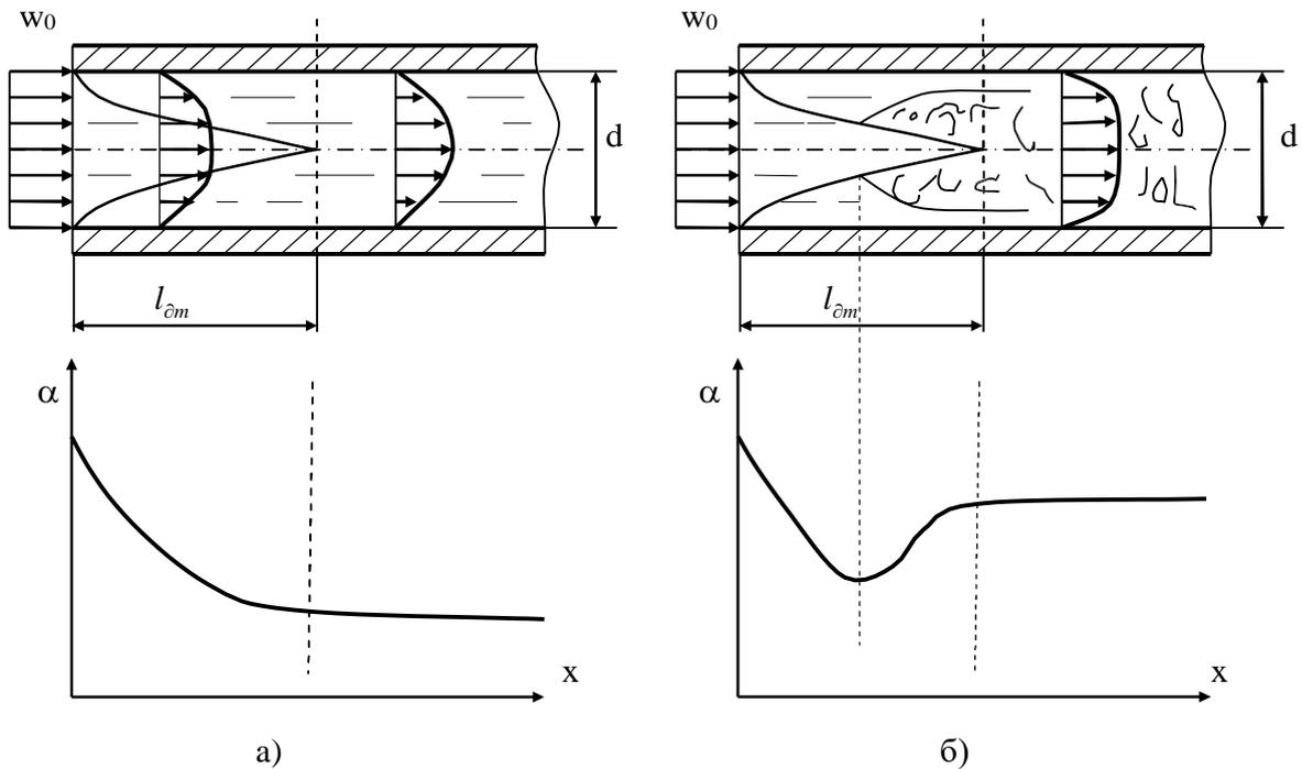
Рисунок 3.1. Динамическая стабилизация и теплоотдача жидкости в трубе: а) ламинарное течение; б) турбулентное течение.
