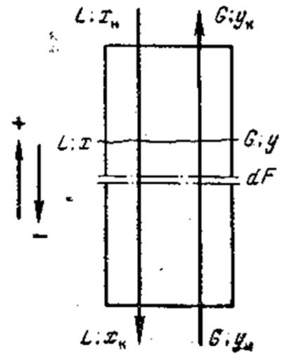
Направление массопередачи можно определить с помощью линии равновесия и рабочей линии. Пусть массопередача происходит между фазами  $\Phi_x$  и  $\Phi_y$  с рабочими концентрациями  $\bar{X}$  и  $\bar{Y}$  соответственно.
