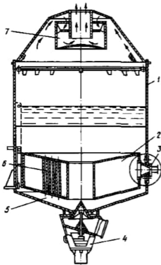
Вакуум-аппарат с естественной циркуляцией периодического действия с подвесной греющей камерой показан на рис. 23.3. Греющая камера состоит из двух конических трубчатых решеток, в которых развальцованы греющие трубы. По оси греющей камеры расположена циркуляционная труба. Между корпусом греющей камеры и стенками аппарата имеется кольцевое пространство, в котором циркулирует утфель.
