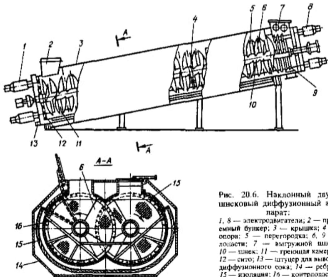
Рис. 20.6. Наклонный двухшнековый диффузионный аппарат;
