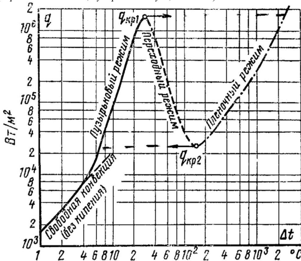
На рисунке показано изменение теплового потока, отводимого в жидкость, при её кипении.
